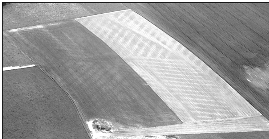
Obr. 1. Typické vizuální projevy fungujících drenáží na panchromatickém leteckém snímku na ploše zapojeného porostu obilovin (tmavé linie oproti okolí) a holé orné půdy (světlé linie) (povodí Žejbra, Pardubický kraj, 2006). Zdroj: VÚMOP, v. v. i.
