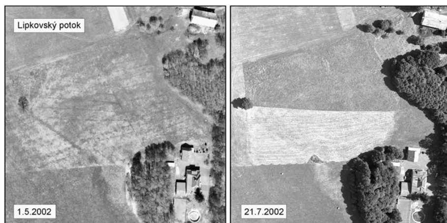
Obr. 2. Ukázka časových změn ve vizualizaci drenáží na leteckém snímku trvalého travního porostu – zřetelný jarní (1. 5. 2002) a nezřetelný letní projev (21. 7. 2002) podle vývojového stádia, stavu a ovlivnění porostu agrotechnickými zásahy (kosením) (Dolní Lipka, Pardubický kraj, 2002). Zdroj: VÚMOP, v. v. i.
