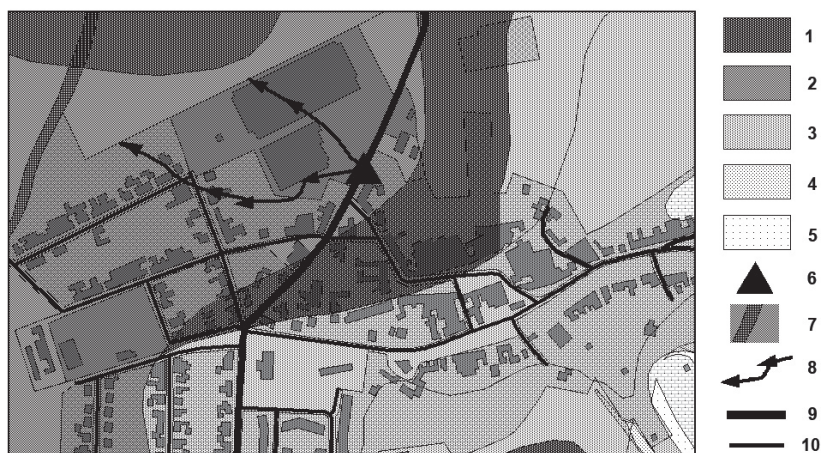
Obr. 2. Generování cenové mapy pozemků z dostupných dat pro potřeby výběru optimální trasy k místu zásahu a k lokalitě vybudování záchytné bariéry povrchového odtoku polutantu v údolí Svítavy. Zdroj: data Českého úřadu zeměměřického a katastrálního, Praha a Výzkumného ústavu meliorací a ochrany půdy, Praha
