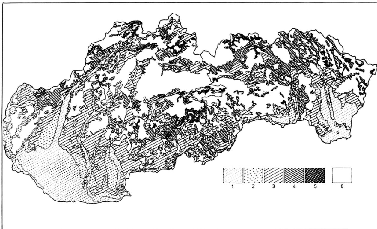
3. Návrh protieróznych pásov zelene: 1 — do 300 až 400 m; 2 — do 200 až 300 m; 3 — do 100 až 200 m; 4 — do 50 až 100 m; 5 — návrh na trvalú ochrannú zelen.
