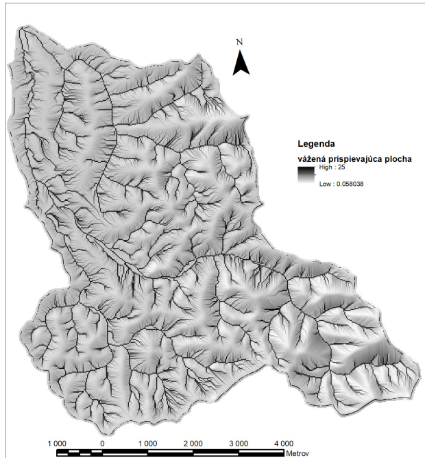
Obr. 2: Vážená prispievajúca plocha vyjadruje spôsob integrácie odtoku v povodí.
